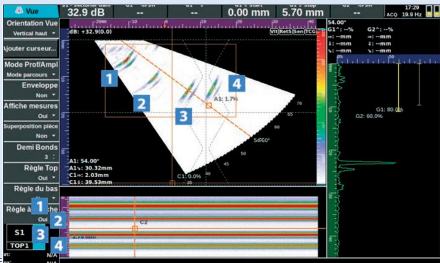
Figure 4 : Image CScan obtenue à partir du balayage sectoriel ci-dessus : 4 indications sont clairement différenciées sur le fond blanc.
